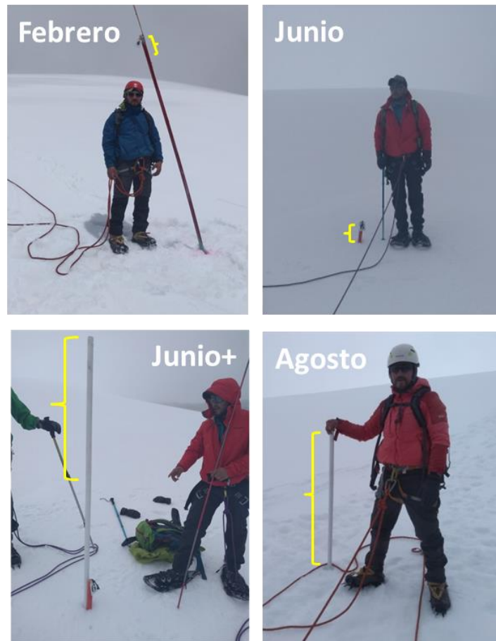
Fotografía 2. Baliza No.6 (5010m.). Nótese los cambios comparando el símbolo de llave. En Junio se reinstaló la baliza (junio+). Autor: J. Ceballos.
