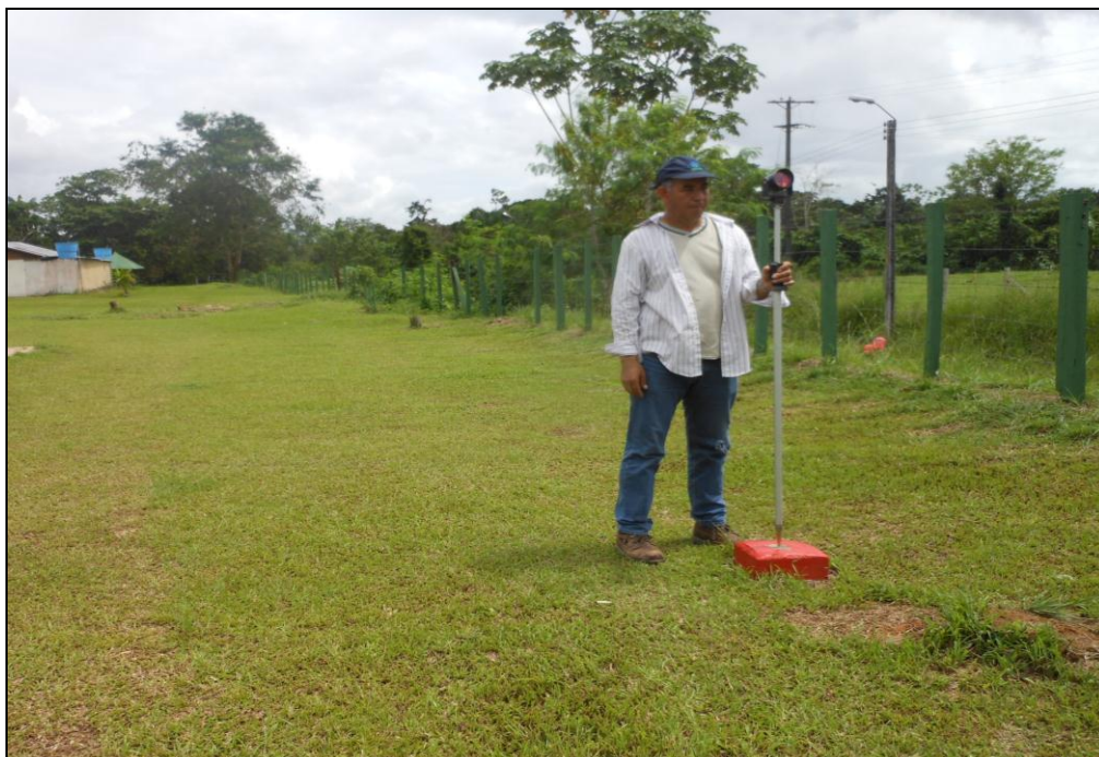
Figura 8. Prima y porta prisma geo referenciando un vértice.
