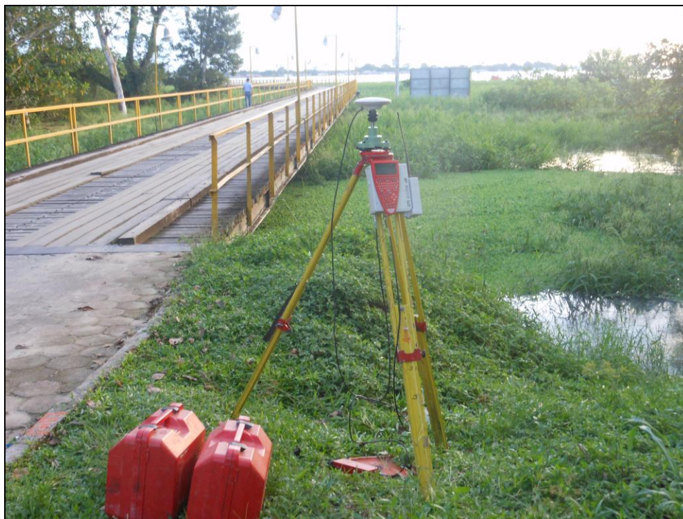
Figura 5. GPS de precisión, georreferenciando el BM de la estación.
