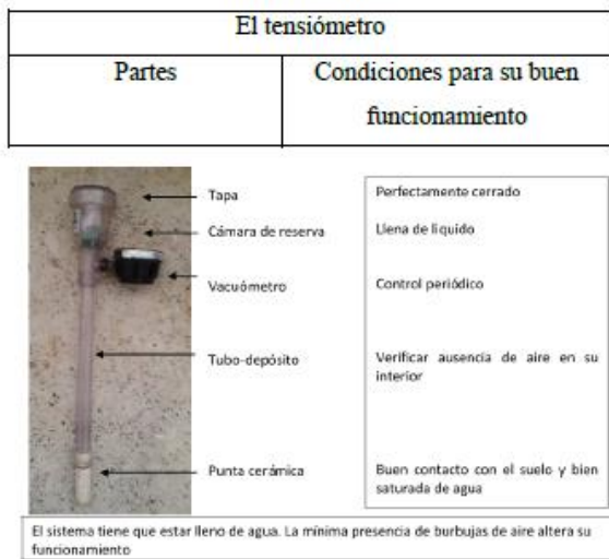
Figura 1. Partes del tensiómetro de suelo y condiciones para su buen funcionamiento.
