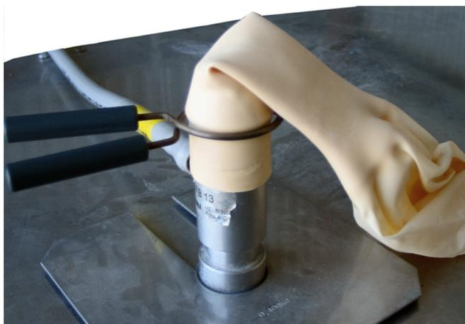
**Ilustración 4** Cuello del globo asegurado con una abrazadera
