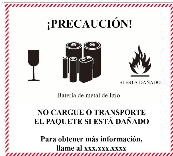
**Ilustración 20 Etiqueta de manipulación de baterías de litio**
