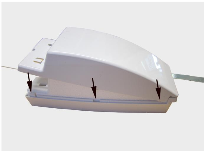
**Ilustración 30 Encaje de las cubiertas de la radiosonda**
