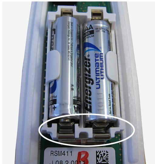
**Ilustración 27** Pinza de resorte del soporte de la batería RS41
