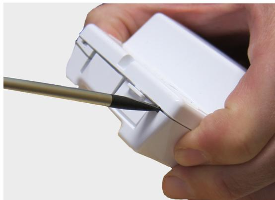
**Ilustración 22 Apertura de la cubierta de la radiosonda**
