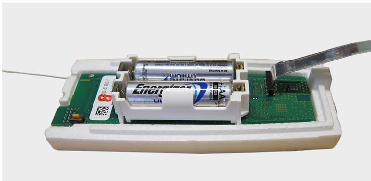
**Ilustración 25** Baterías RS41 en el soporte de la batería
