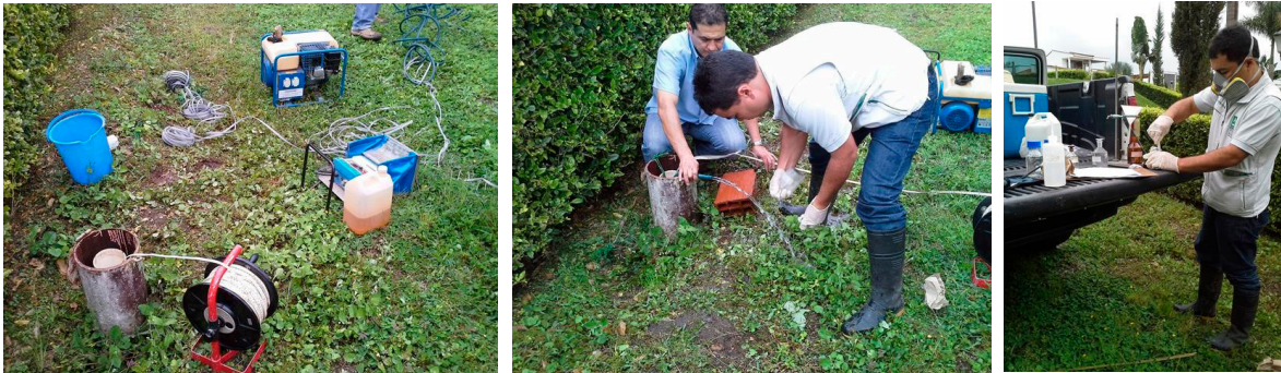
Figura 30. Equipos empleados para recolección de muestra de aguas subterráneas en piezómetro, para análisis físicoquímicos (equipo técnico de Carder, 2013).
