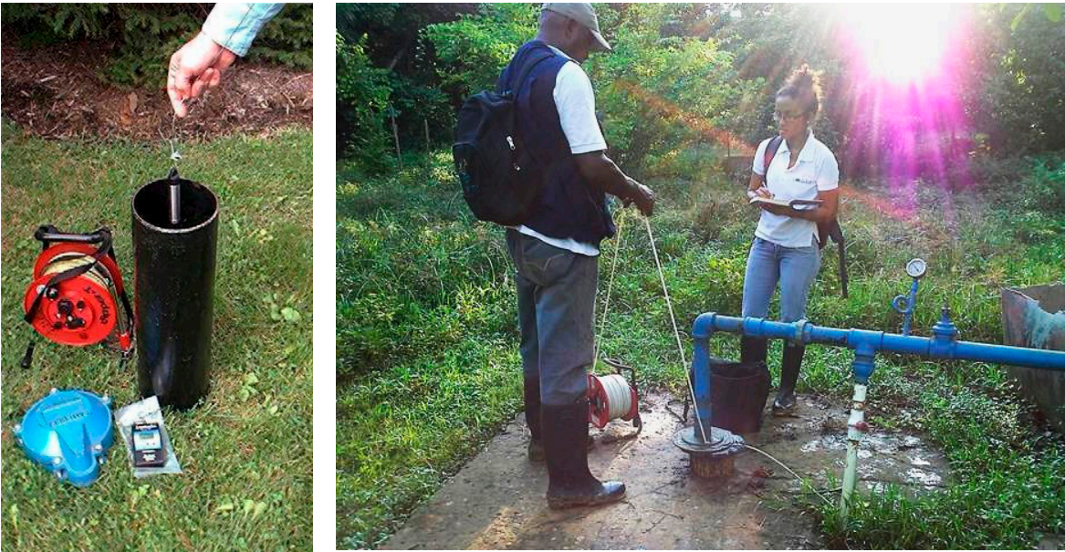
Figura 27. Monitoreo automático (diver) y manual (cinta métrica).
