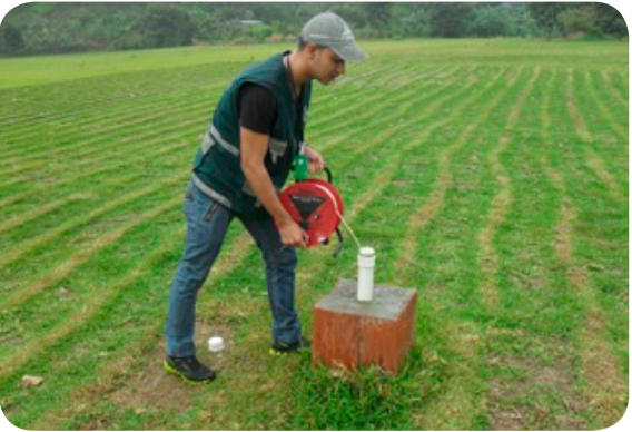
Figura 6. Piezómetro ubicado en la jurisdicción del AMVA.
