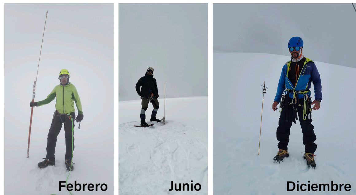
Figura 37. Comportamiento de la baliza o estaca de ablación N.º 10, instalada sobre la superficie del sector glaciar Ritacuba Blanco, Parque Nacional Natural El Cocuy, durante febrero, junio y diciembre.
