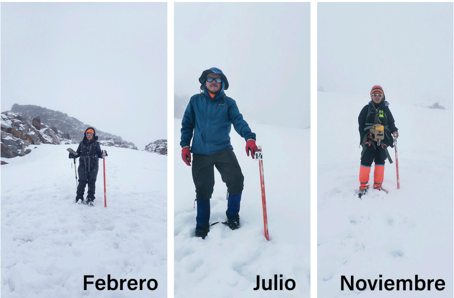
Figura 22. Comportamiento de la baliza o estaca de ablación N.º 14, instalada sobre la superficie del glaciar en la zona de acumulación, durante febrero, julio y noviembre, en el sector glaciar Conejeras, Parque Nacional Natural Los Nevados.
