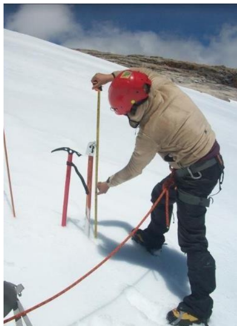
Figura 5. Medición de la emergencia de una baliza.
