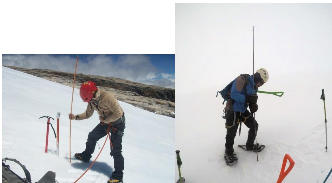
Figura 8. Sondeo del espesor de nieve en el monitoreo glaciar.
