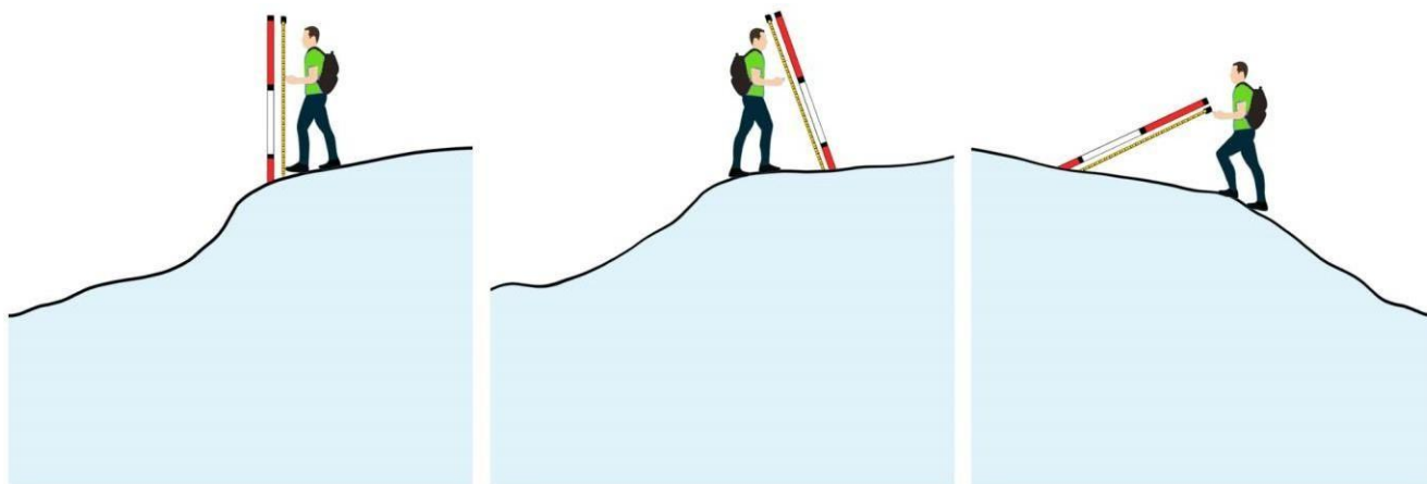
Figura 7. Ejemplo de medición de una baliza recta o inclinada en el terreno.
