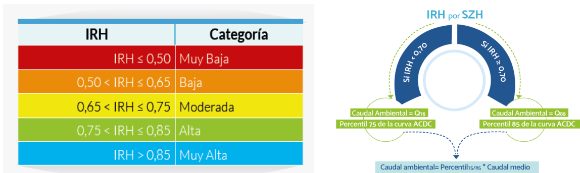
Figura 2. 20. Esquema de cálculo y categorización del IRH y del caudal ambiental
