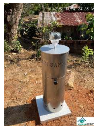
Figura 2.48. Izquierda: totalizador comercial con tubo sumergido instalado en la zona de interés. Derecha: totalizadores instalados en las estaciones climatológicas del Ideam de Remedios (Antioquia) y en Puerto Berrío (Antioquia)
